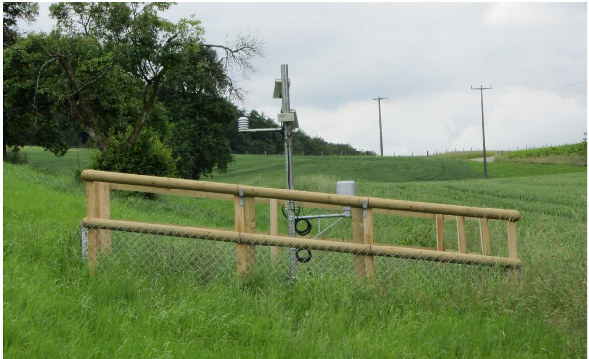
**Fertig installierter und ausgerüsteter Mast mit den Messgeräten. Aufgrund des geringen Abstandes zum Wald wurde die Station mit einem Zaun und drei Querlatten gesichert.**
