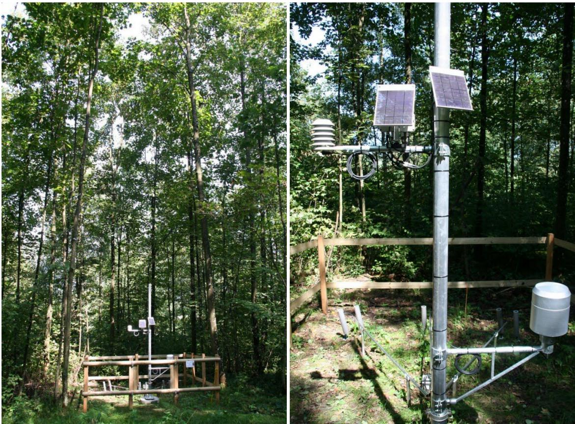
*Gesamtansicht der Station (links), Nahaufnahme Solarpanels und Vaisala-Sonde, sowie Regenmesser (rechts)*
