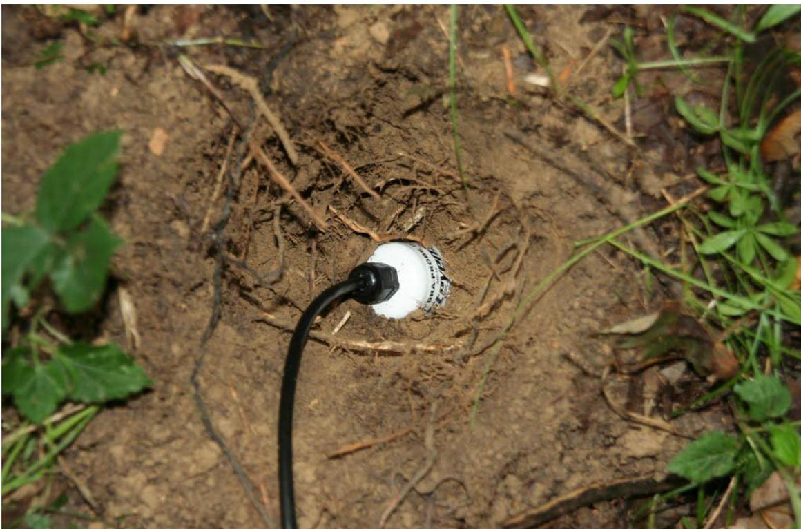
*Eingebaute Stevens-Sonde zur Messung des Wassergehaltes*
